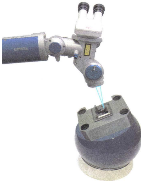
Laserschweißen an der Kontur Fokussierobjektiv 150 mm
