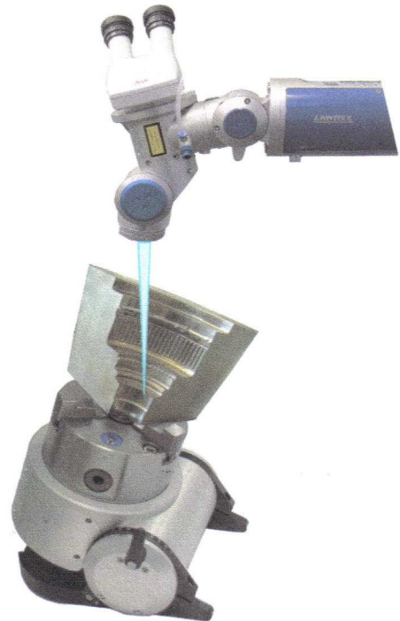
Laserschweißen in der Vertiefung Fokussierobjektiv 300 mm
